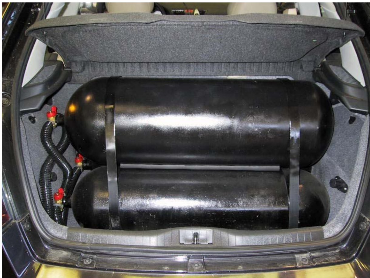
Installazione bombole metano.
