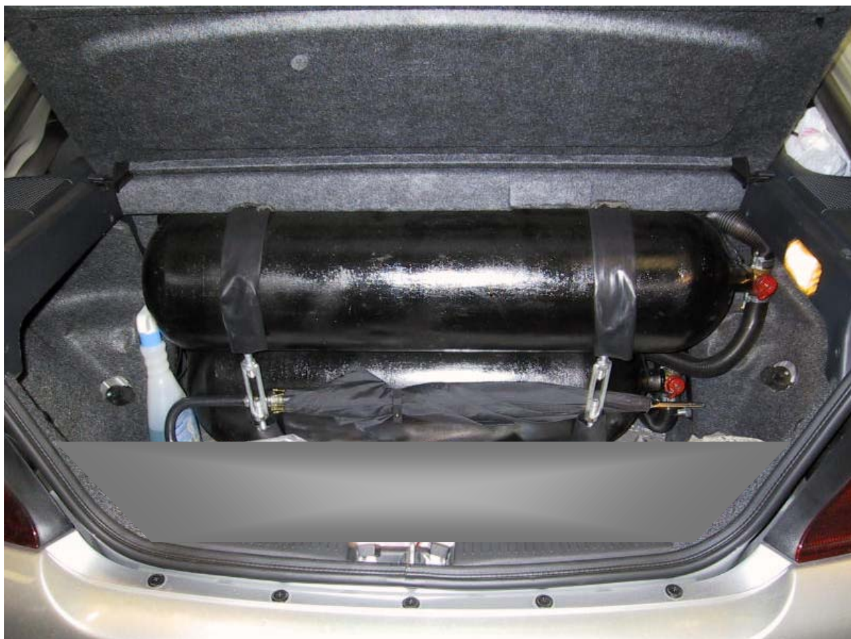
Installazione bombole metano.
