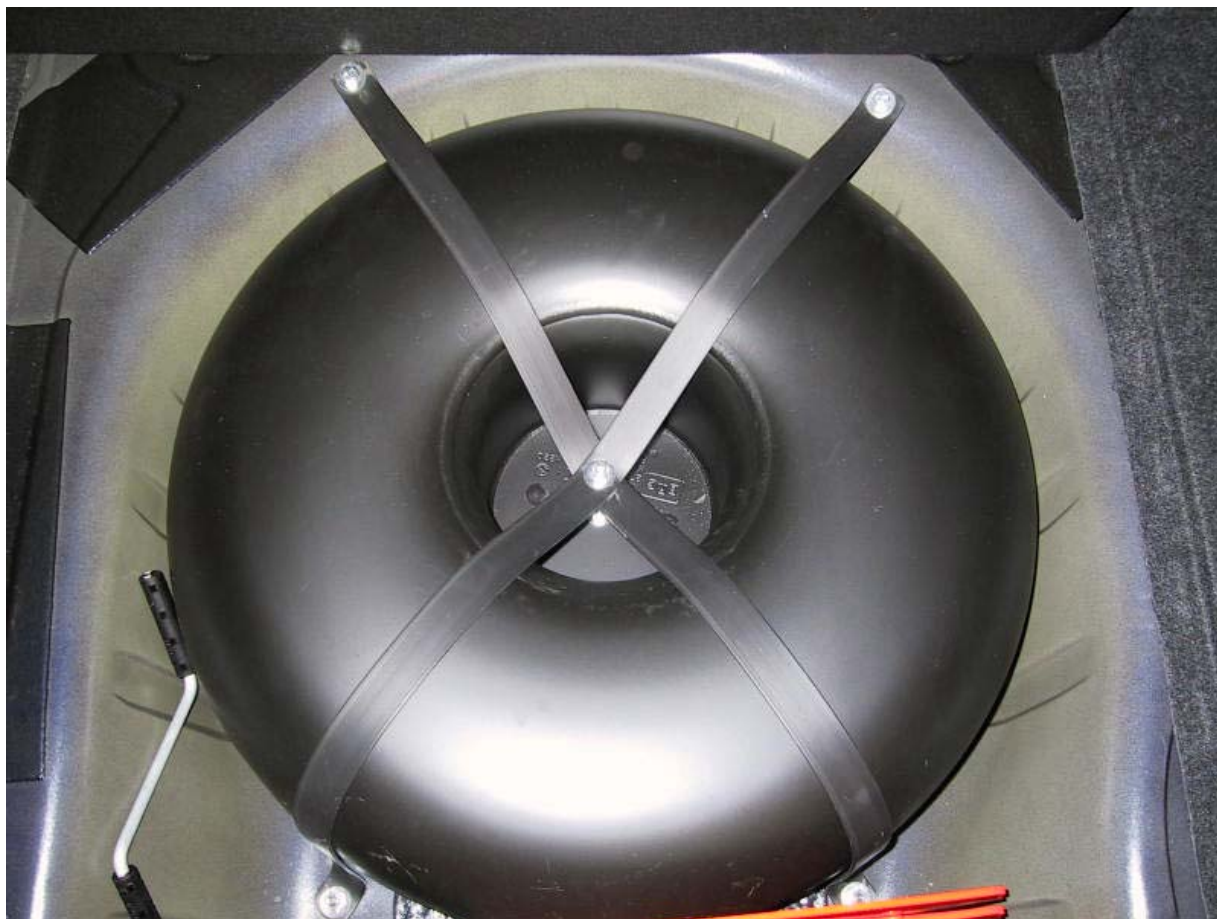
Installazione serbatoio del gas
