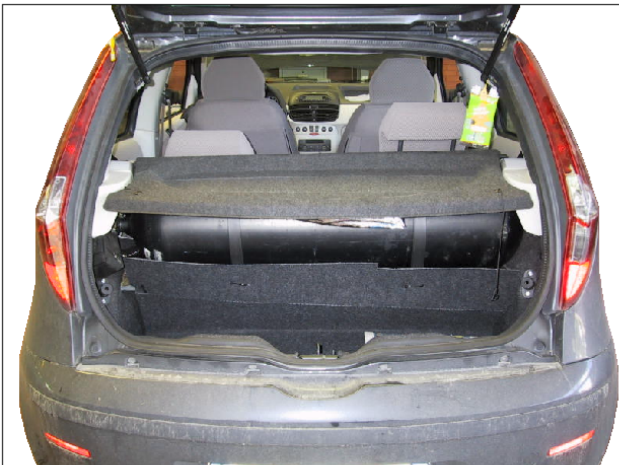
Installazione bombole metano.
