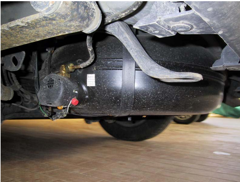
Installazione serbatoio del gas
