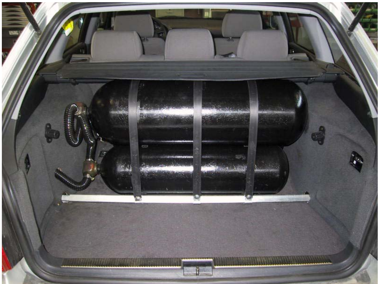
Installazione bombole metano.
