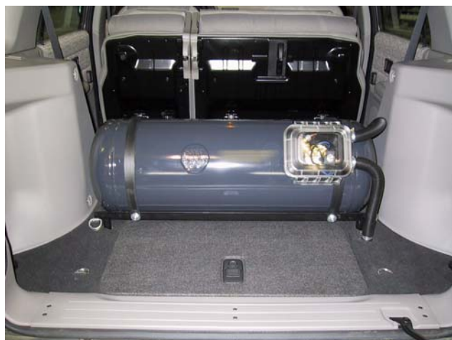
Installazione serbatoio del gas, tramite il kit dedicato
