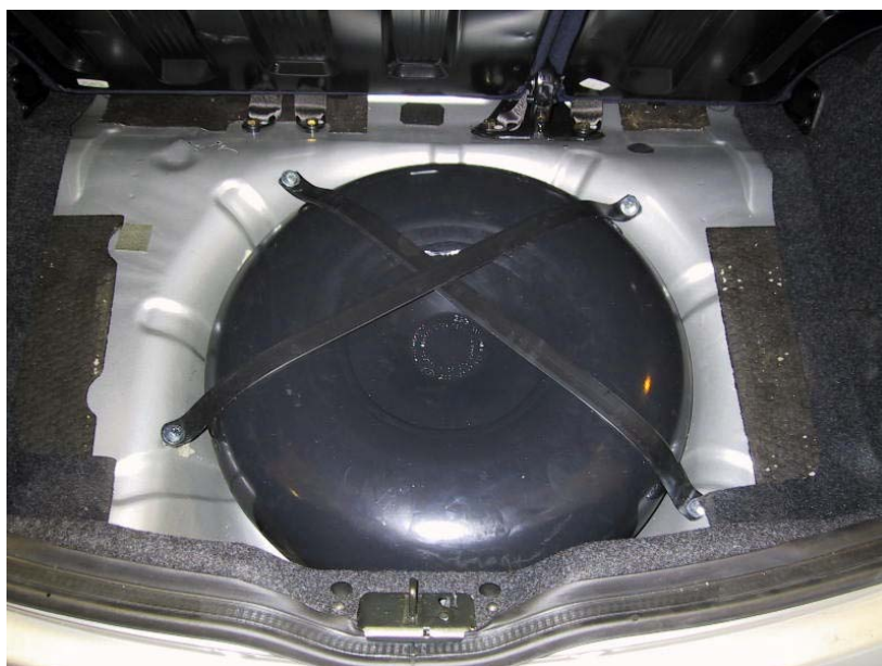
Installazione serbatoio del gas
