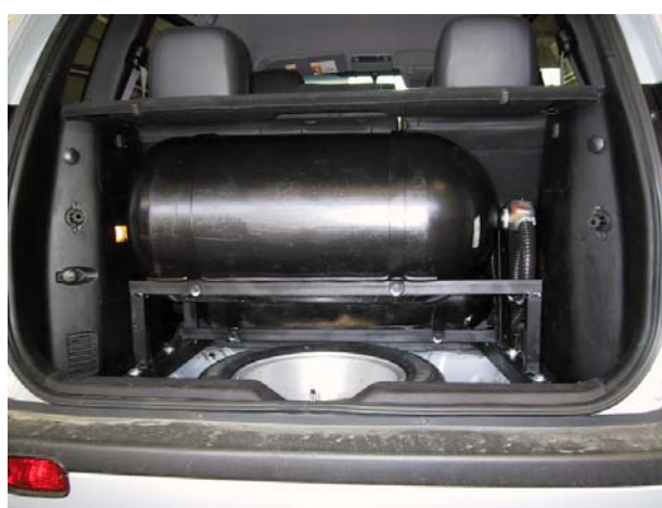
Installazione delle bombole metano
