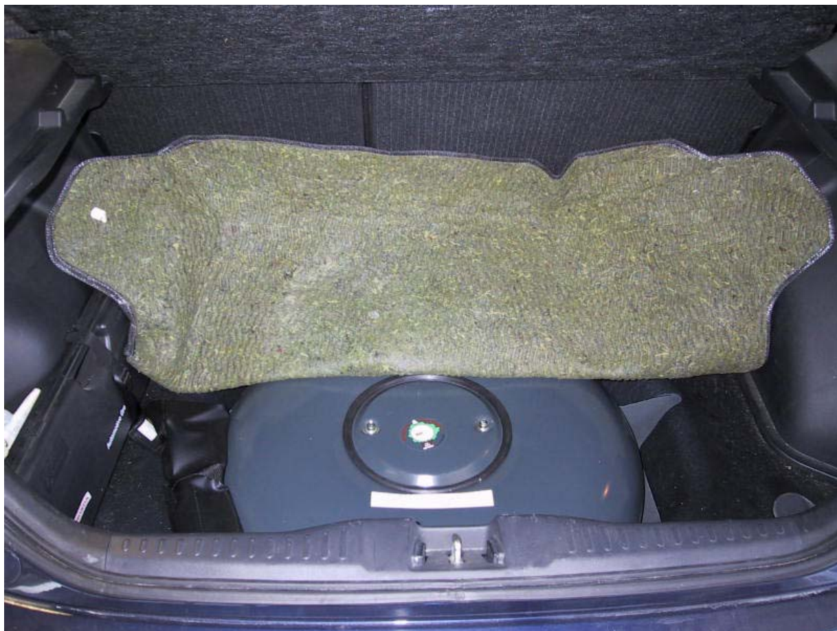
Installazione del serbatoio gpl
