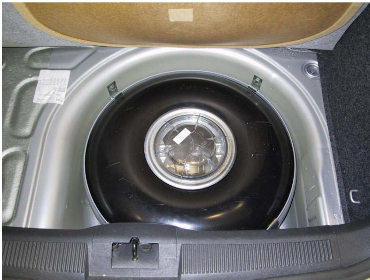
Installazione del serbatoio gpl.
