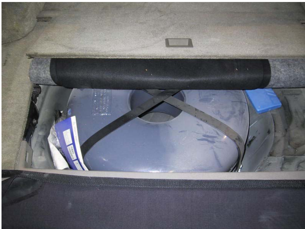
Installazione del serbatoio gpl.
