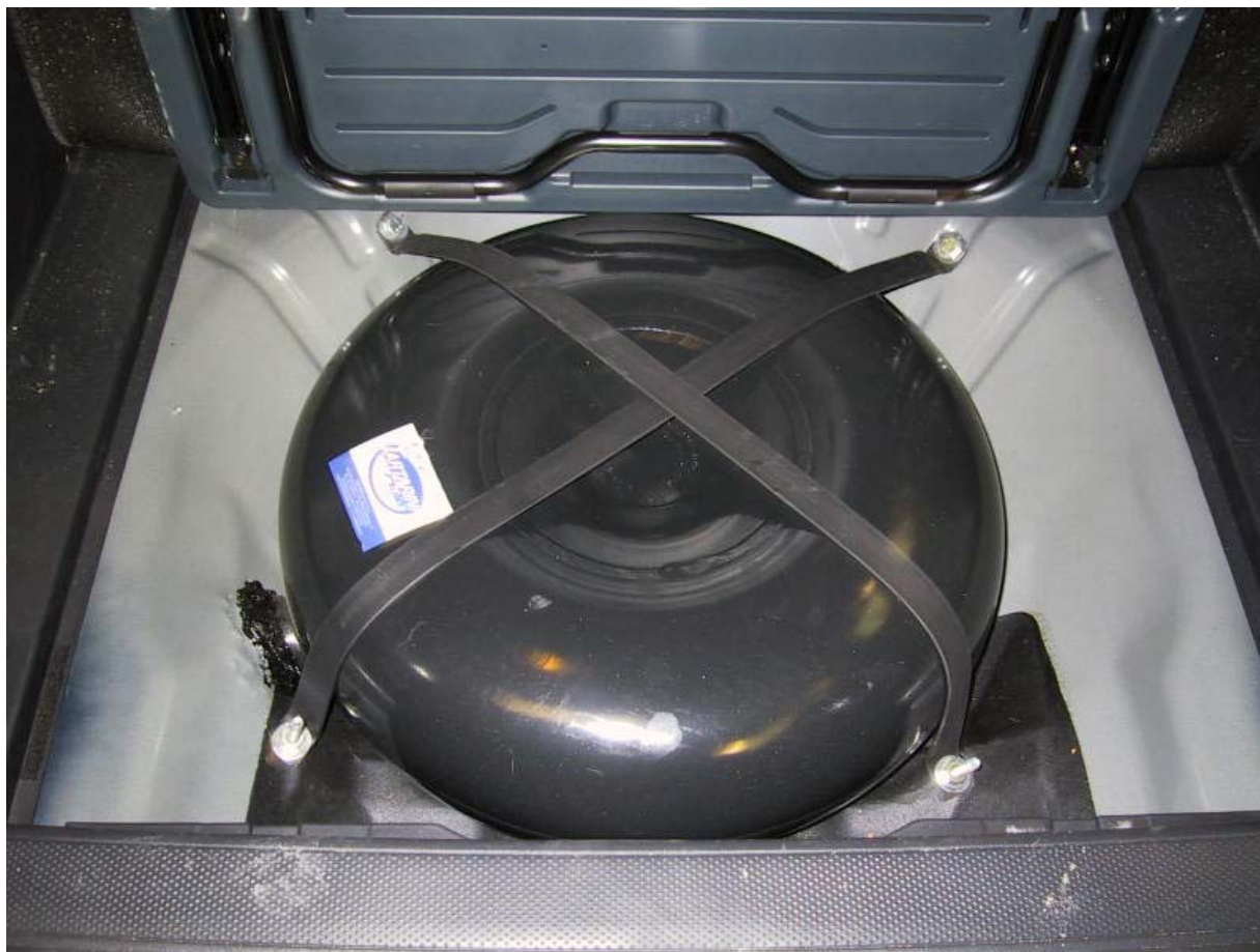
Installazione serbatoio del gas
