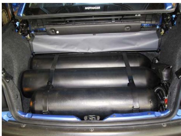
Installazione delle bombole metano
