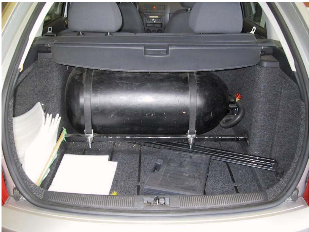
Installazione bombola metano.
