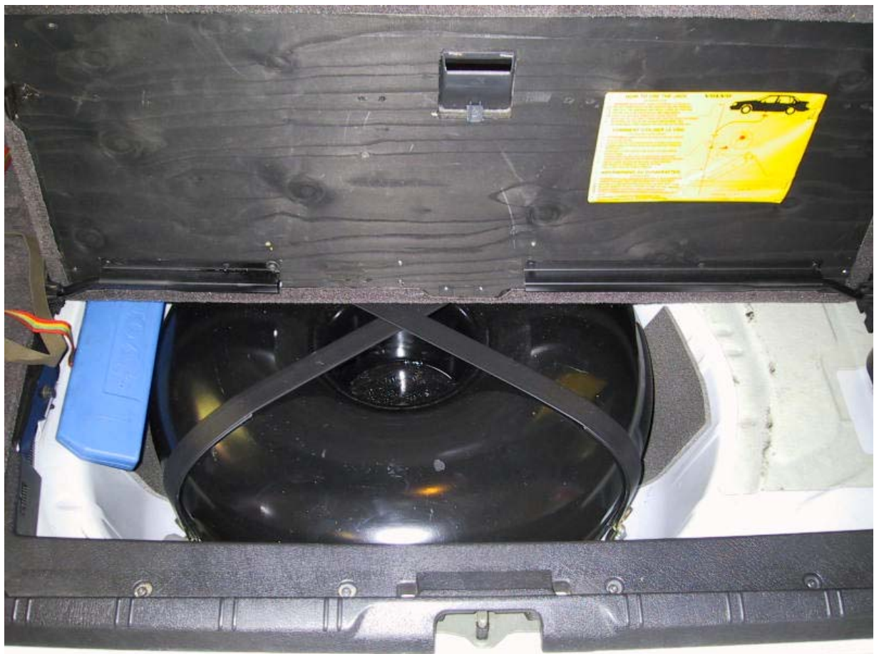
Installazione serbatoio del gas
