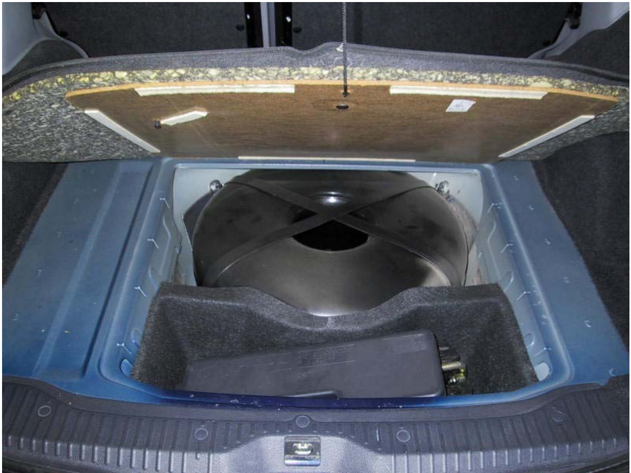
Installazione del serbatoio gpl
