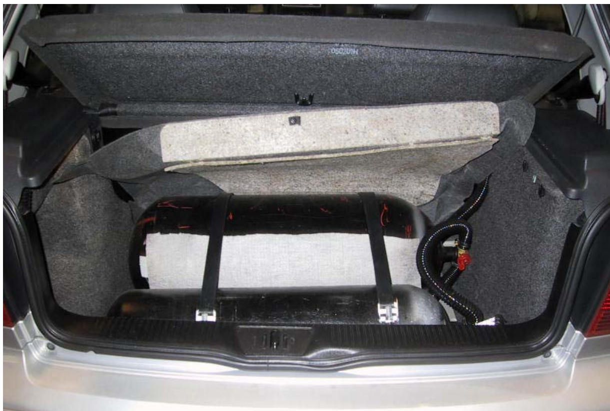
Installazione bombole metano.
