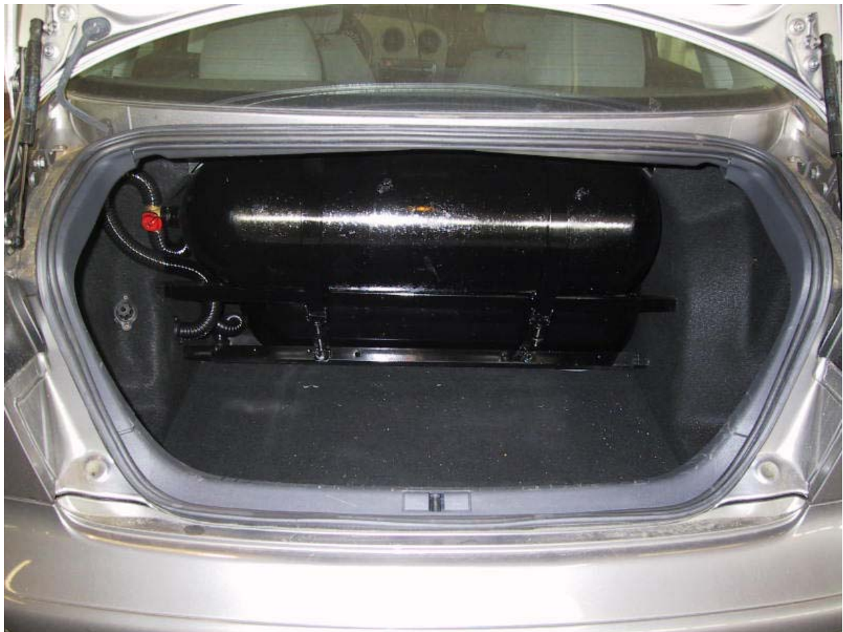
Installazione bombole metano.
