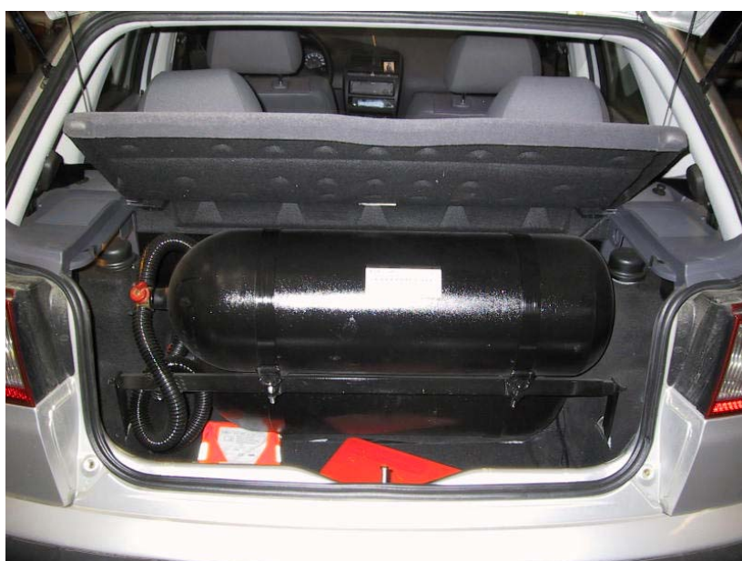
Installazione bombole metano.
