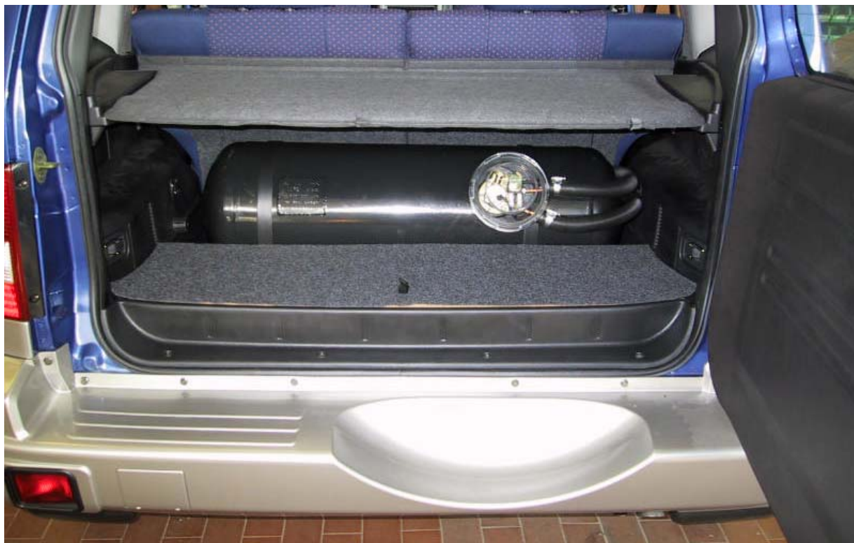
Installazione serbatoio del gas
