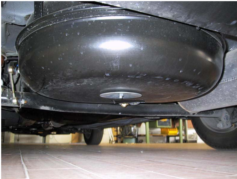
Installazione serbatoio del gas
