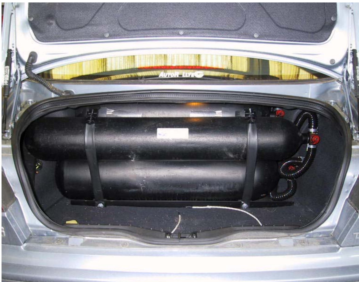
Installazione bombole metano.
