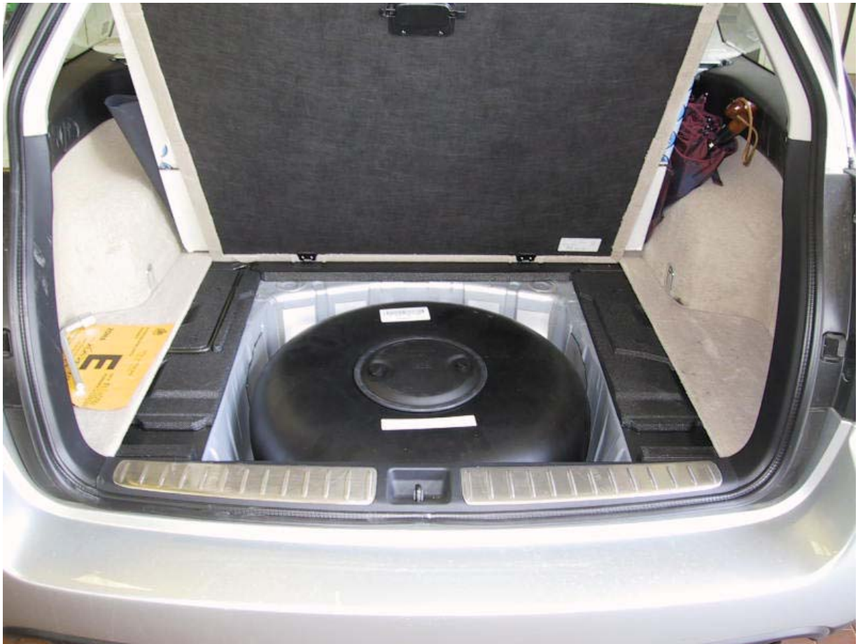
Installazione del serbatoio gpl
