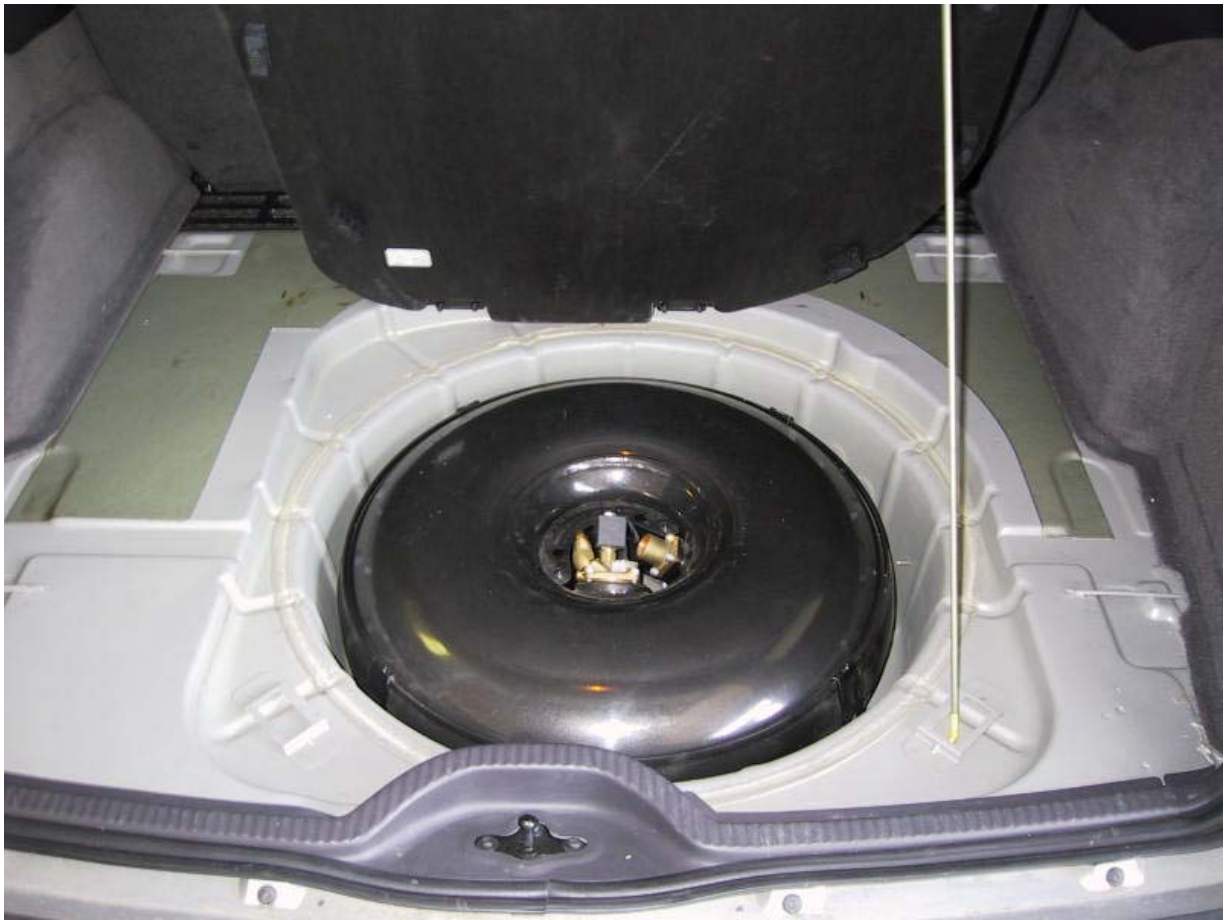
Installazione serbatoio del gas
