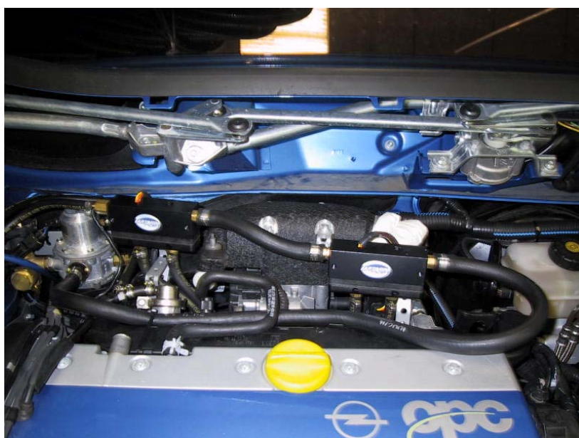
Posizione gruppo iniettori e riduttore gas.
