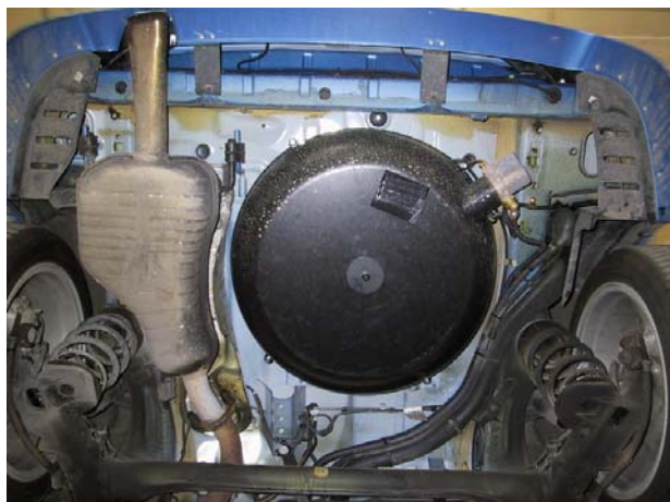
Installazione serbatoio del gas.
