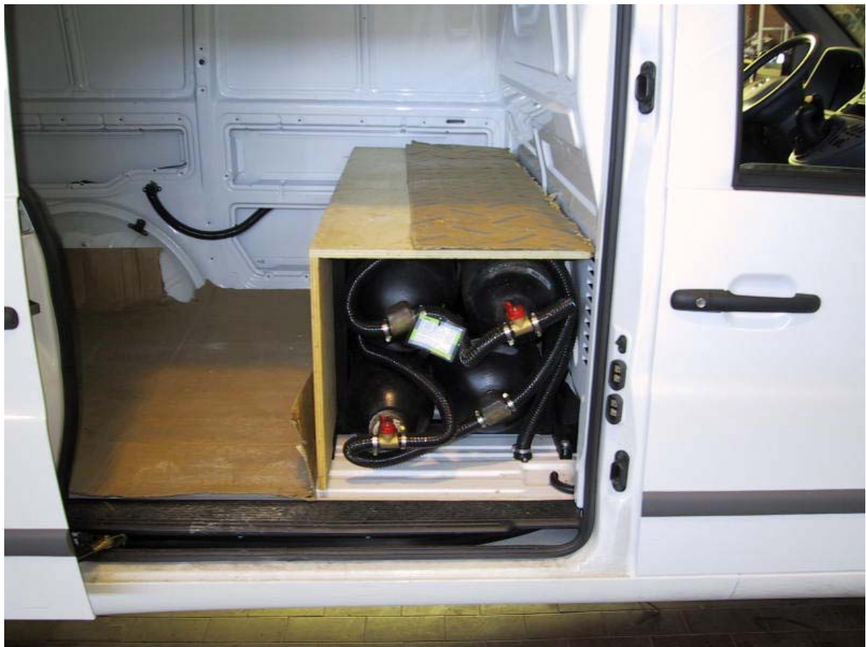
Installazione bombole metano.
