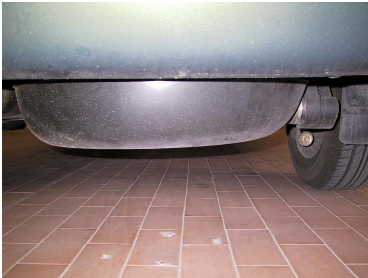
Installazione serbatoio del gas
