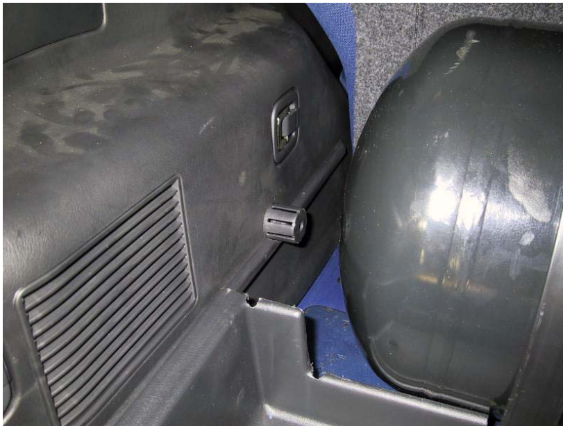
Posizione sfiato areazione sul passaruota.
