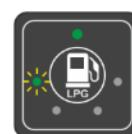
В баке резервный остаток топлива
