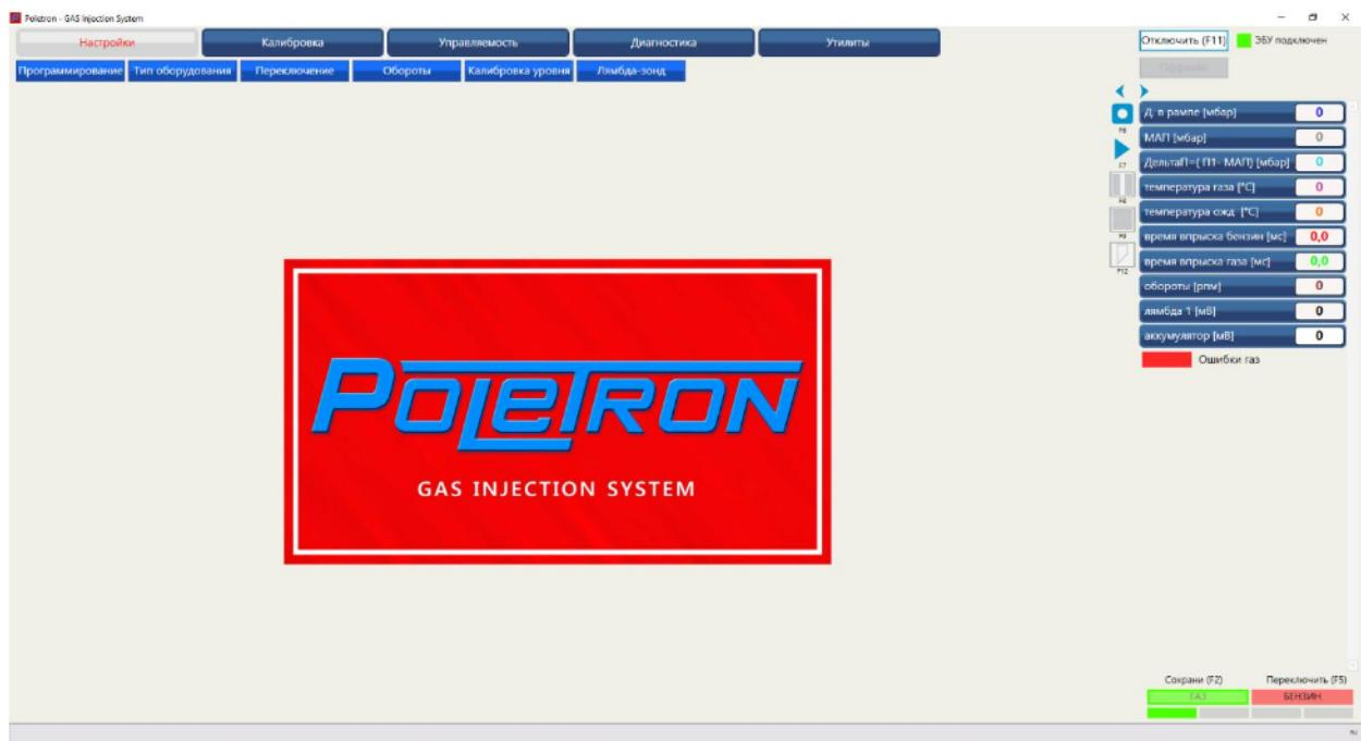
Окно состоит из нескольких частей. В правой части экрана расположены текущие параметры. Для отображения этих параметров необходимо запустить процесс считывания данных из контроллера. Сделать это можно двумя способами:
