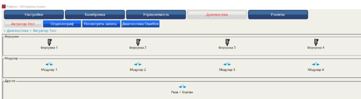
В данном разделе можно управлять исполнительными механизмами: газовыми форсунками, газовыми клапанами, а также можно проверить правильно ли подключены провода к бензиновым форсункам.
